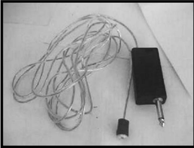
**Gambar 2:** Mini Mikrofon yang Sudah Dikemas
